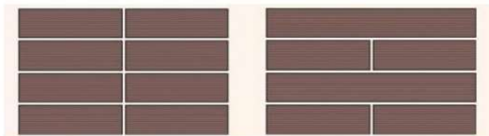
Obr. 8 – pokládka WPC desek
