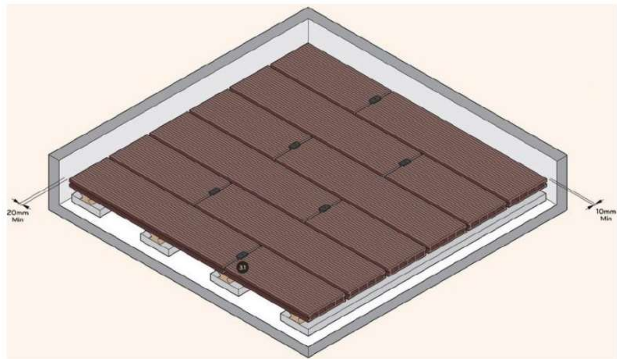
Obr. 7 – pokládka WPC desek s dodržáním dilatačních mezer
